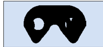
RPV- und RP-Zapfensystem mit sichelförmigen Zapfen
