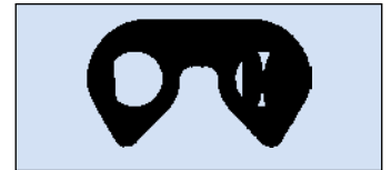
SC-Zapfensystem mit D-förmigen Zapfen
